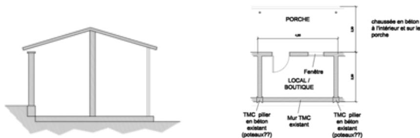
Los puestos de venta serán de 2,5x4x2,5 m. con una ventana y una puerta.: dispondrán de luz y electricidad. Su construcción será hecha con BTC fabricado en nuestras instalaciones con la máquina que disponemos.
